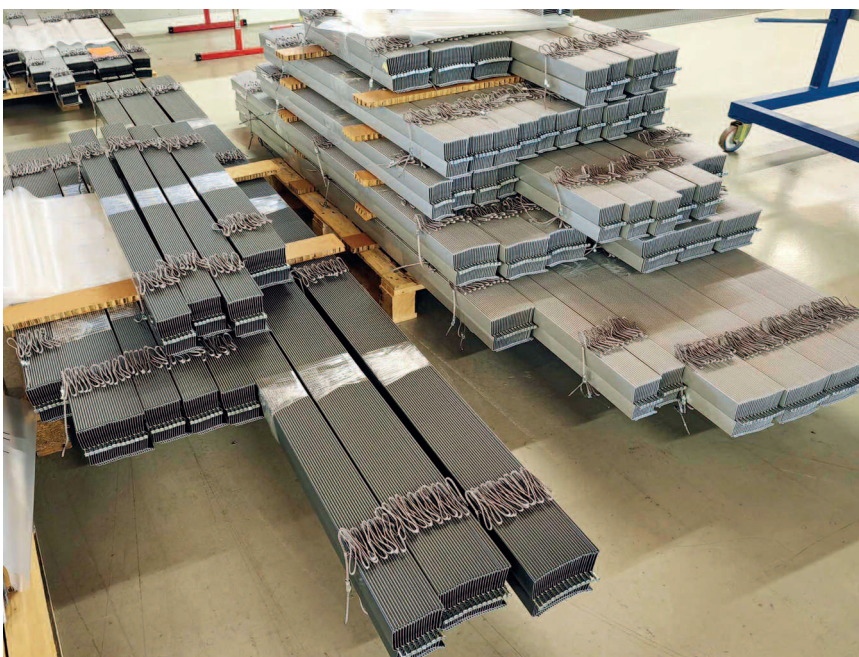
Bei den fertig montierten Lamellenpaketen spielt die gleichmäßige Stapelbildung eine wichtige Rolle
