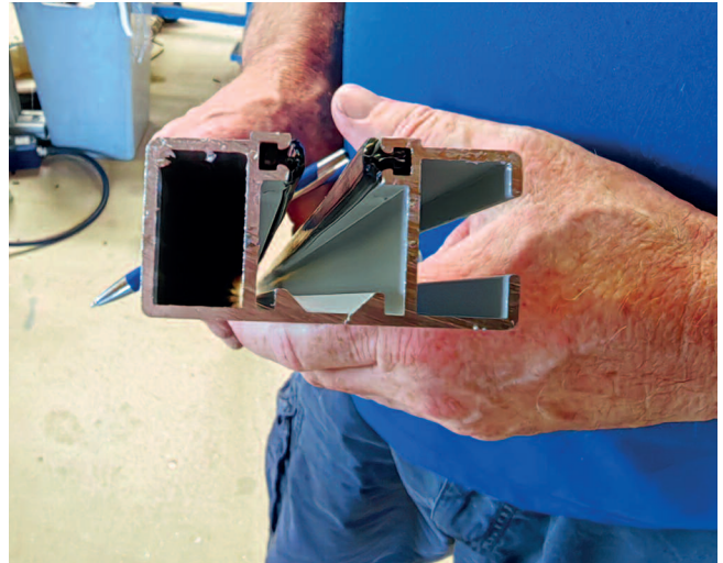
Auch bei diesen Kernen, welche in den seitlichen Führungsschienen der Storen als Gleitflächen fungieren, konnte mobil Kunststoffprofile auftretende Probleme beheben
