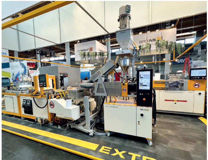
Messe-Highlight COLLIN LAB LINE Flachfolienanlage mit Co-Extrusion 2-Schichtfolie mit Streifen (©COLLIN Lab & Pilot Solutions)
