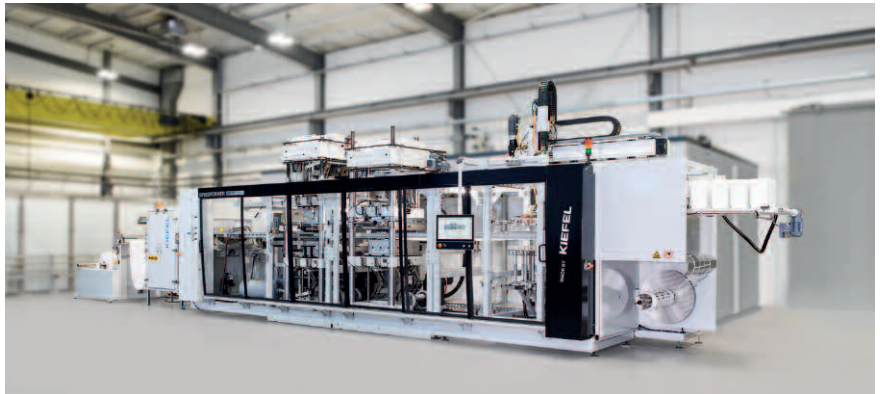
Die neue KMD 78.2 Premium bietet einen höheren Ausstoß an Polymerverpackungen und erreicht bis zu 45 Takte/Minute (Bilder© KIEFEL GmbH)
