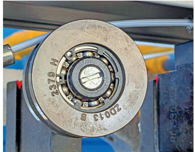
Das von einer großen Spule zugeführte Kederprofil wird kurz vor dem Umformen des Randes der Lamelle über eine Umlenkrolle von unten ins Walzwerk eingefädelt
